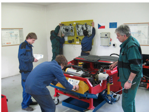
40. Simulační autopanel: „Vícebodové vstřikování paliva“.
