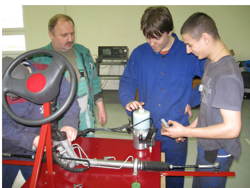
38. Simulační autopanel: „Elektrohydraulické servořízení“.
